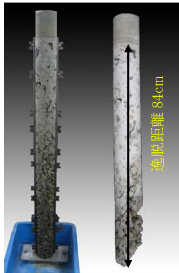
砂利: 1日後の固結状況
