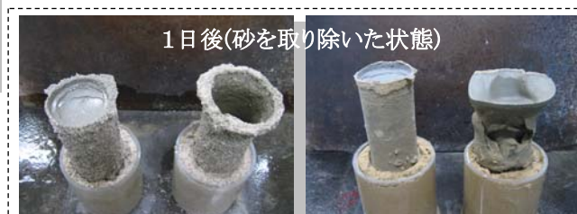
無添加セメントミルクは逸水により壁面が崩壊
