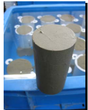
3時間後の脱型状況
